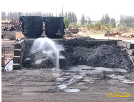
ภาพที่ 2.2-12 การนำน้ำทิ้งจากระบบหล่อเย็น กลับไปใช้ประโยชน์ในโรงงาน Slag Processing
