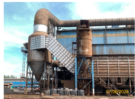
ภาพที่ 2.2-20 ไซโลเก็บรวบรวมฝุ่น จากระบบ Bag Filter House ของโรงงาน
